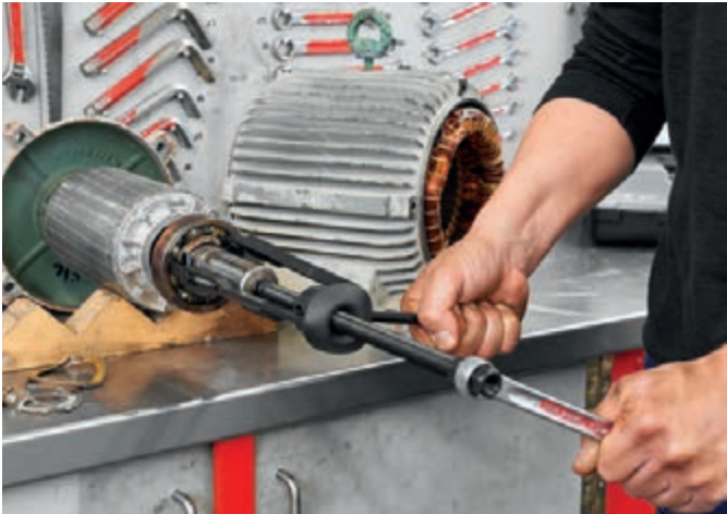
Der Twin Puller TP 150 schafft's: Ein festsitzendes Lager eines Elektromotors wird ohne Beschädigung der Welle demontiert.
