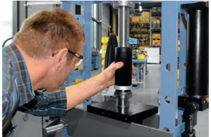
Das FT-P ist die ideale Lösung bei Montagen mit grösseren Einbaukräften, da das Werkzeug auf Pressen eingesetzt werden kann. Hochwertige Aluminiumringe, die sich auch bei Einpresskräften von 5 Tonnen nicht verformen.
