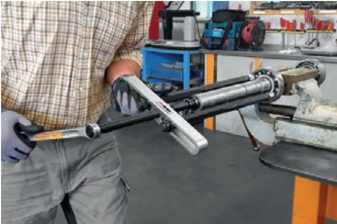
Der Ausbausetz BP 160 ermöglicht mit Hilfe von Verlängerungen, auch schwer erreichbare Lager einfach und fachgerecht auszubauen.
