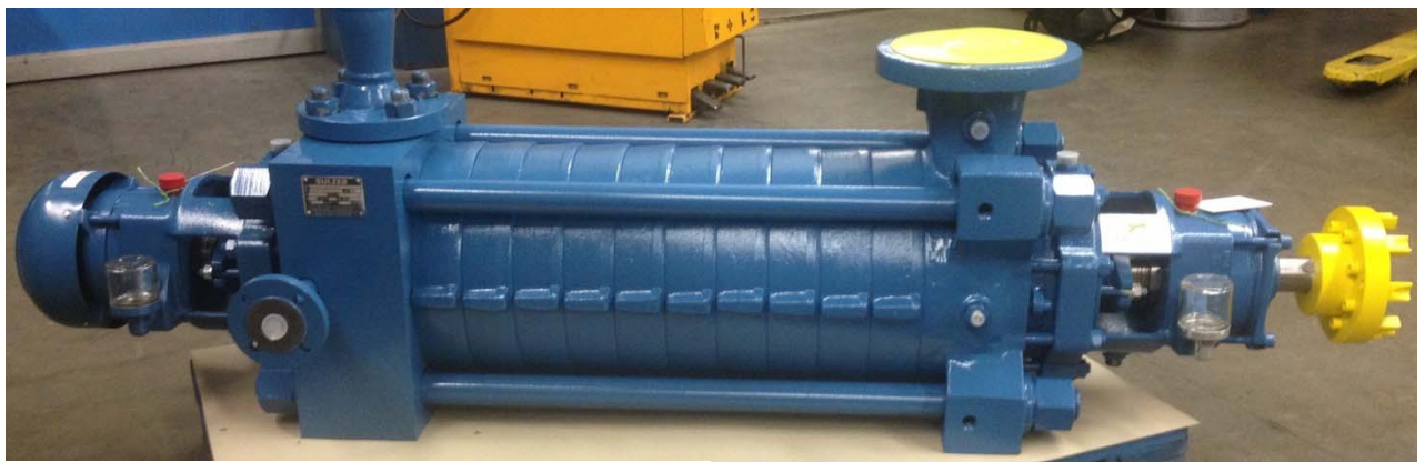
Instandgesetzte, auslieferbereite Pumpe
