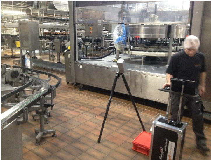
Massaufnahme mit Flexi-Jet Messsystem
